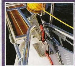
Pratique Une chèvre en V qui se replie sur l'étrave permet de mâter et démâter tout seul.
