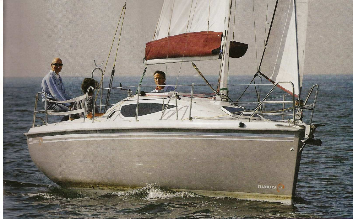
▲ L'ancrage des haubans est surélevé pour faciliter le démâtage, le mât reposant alors sur le support arrière.
